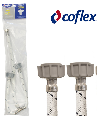
TUBO DE ABASTO PARA FREGADOR Y LAVAMANO 3/8" COMP. X 1/2" A.M. "COFLEX". Trenzado vinilo reforzado, manguera interior "FlexGard", espiga de cobre, férula acero inoxidable, tuerca latón niquelado termoplástico de alta densidad, empaque cónico hule, temperatura trabajo 0°C a 82°C y presión máxima de trabajo 10 kg/ cm 2 /145 PSI. Diámetro interior 5/16" (8.0 mm).
