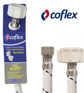
TUBO DE ABASTO PARA INODORO "COFLEX". 3/8" COMP. X 7/8" A.M. Trenzado vinilo reforzado, manguera interior "FlexGard", espiga cobre, férula acero inoxidable, tuerca latón niquelado o termoplástico alta densidad, empaque cónico hule, temperatura de trabajo 0°C a 82°C y presión máxima de trabajo 10 kg/ cm 2 /145 PSI. Diámetro interior 5/16" (8.0 mm).
