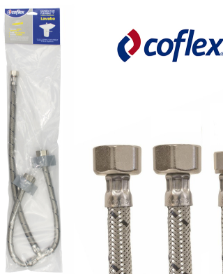
TUBO DE ABASTO PARA FREGADOR Y LAVAMANO EN FORMA "T" "COFLEX". 1/2"A.M. X 1/2" A.M. X 3/8" COMP. Trenzado Vinilo reforzado, manguera interior "FlexGard", espiga cobre, férula acero inoxidable tuerca termoplástica alta densidad, empaque cónico hule, temperatura trabajo 0°C a 82°C y presión máxima de trabajo 10 kg/ cm 2 /145 PSI. Diámetro interior 5/16" (8.0 mm).
