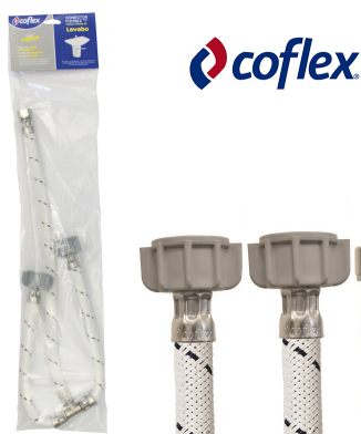
TUBO DE ABASTO PARA FREGADOR Y LAVAMANO EN FORMA "T" "COFLEX". 1/2"A.M. X 1/2" A.M. X 3/8" COMP. Trenzado Vinilo reforzado, manguera interior "FlexGard", espiga cobre, férula acero inoxidable tuerca termoplástica alta densidad, empaque cónico hule, temperatura trabajo 0°C a 82°C y presión máxima de trabajo 10 kg/ cm 2 /145 PSI. Diámetro interior 5/16" (8.0 mm).
